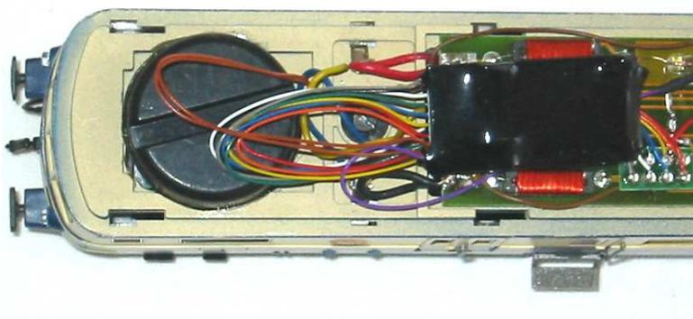
**Und zum Abschluss: Wenn Sie die Schlitze in den Schallkapseln vor der Montage in der Lok mit Epoxy verschließen, klingt's nachher noch besser!**
