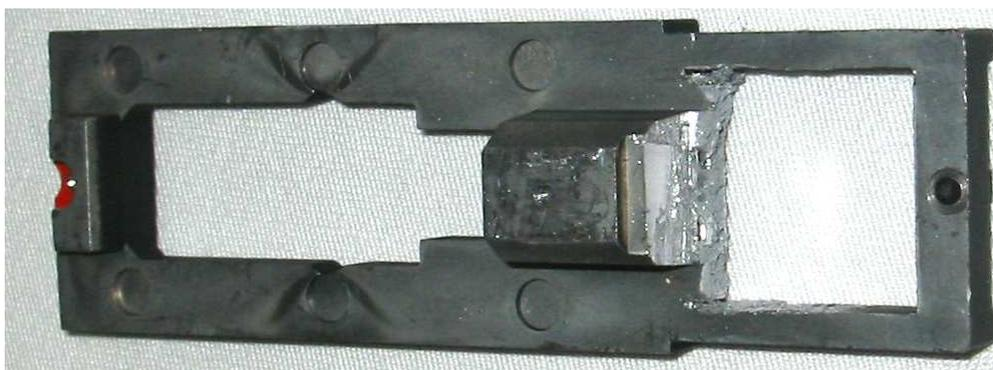
**Die Bruchstelle mit einer Feile glätten, am hinteren Ende eine etwa 3mm tiefe Stufe einfeilen:**
