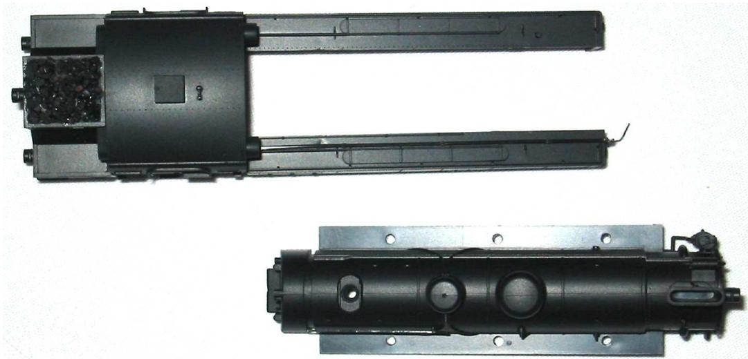
**Das Führerhausdach wird nach oben abgeklipst:**
