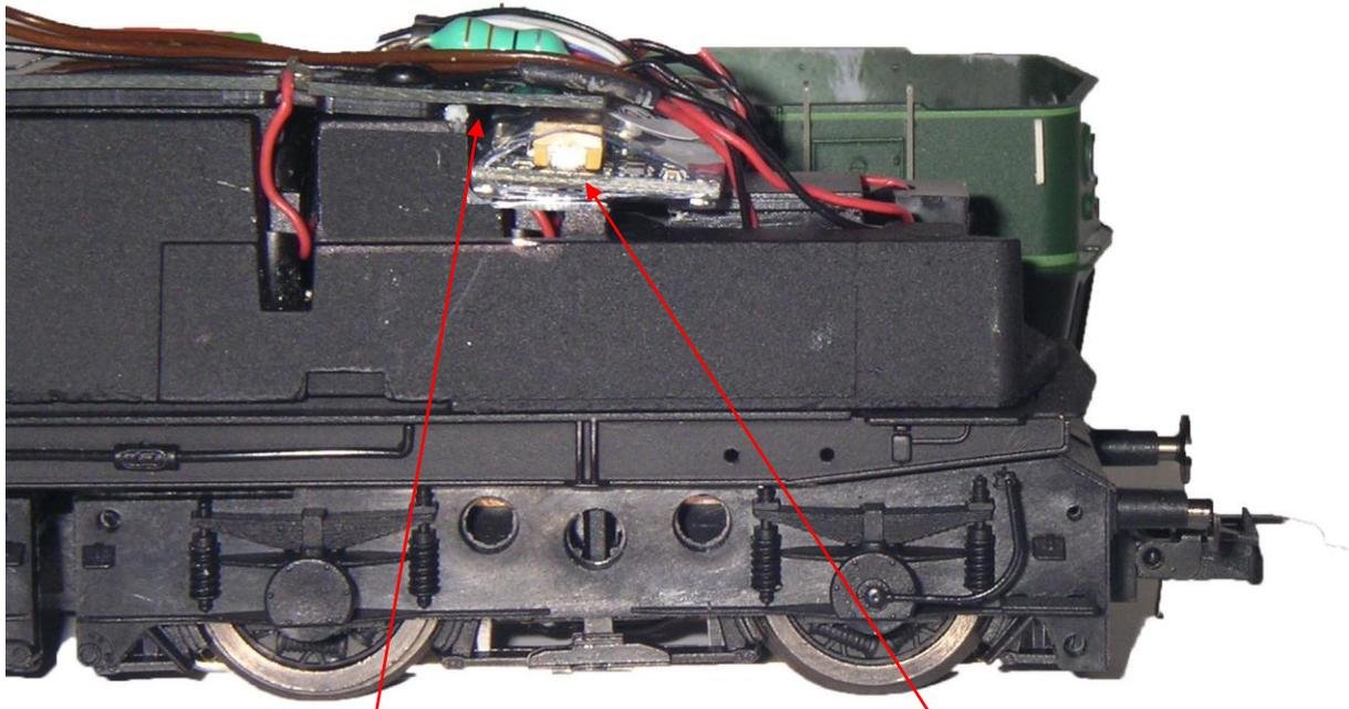
**Unter der Platine liegt ein grauer Kondensator, dieser muß entfernt werden.**
