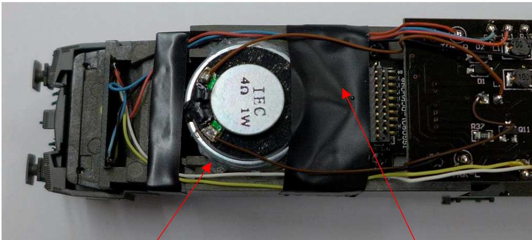
Der Lautsprecher wird mit Sekundenkleber-Gel oder Epoxy Harz fixiert.
