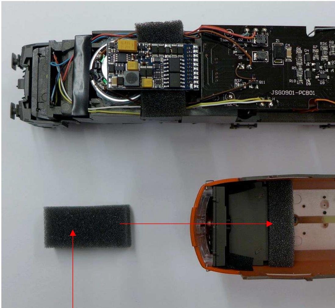
**Schaumstoff (32x16mm) Schaumstoff als Schalldichtung zuschneiden (Verhindert akustischen Kurzschluss) und in das Gehäuse einsetzen.**
